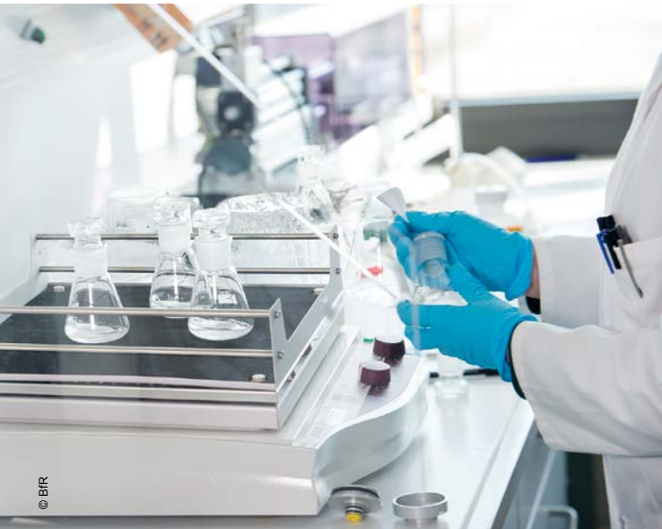
Gerüttelt, geschüttelt, geprüft: Dampf-Bestandteile werden aus dem Filterpolster der Abrauchmaschine herausgelöst und anschließend analysiert.
